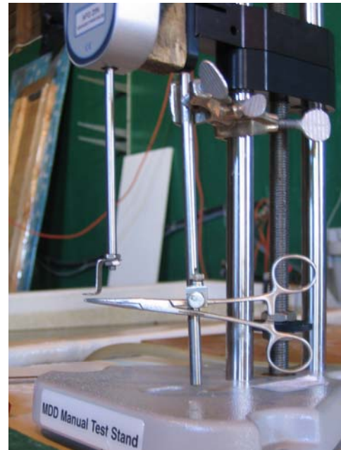
Figure 12. Pince hémostatique utilisée pour fixer les pétoncles lors des mesures à l'air.
