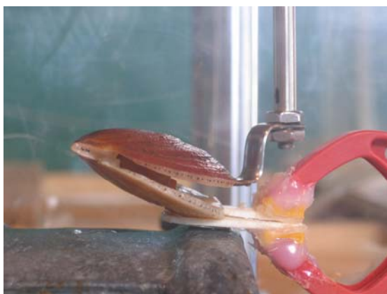
Figure 5. Méthode utilisée pour maintenir le pédoncle en place lors des enregistrements.
