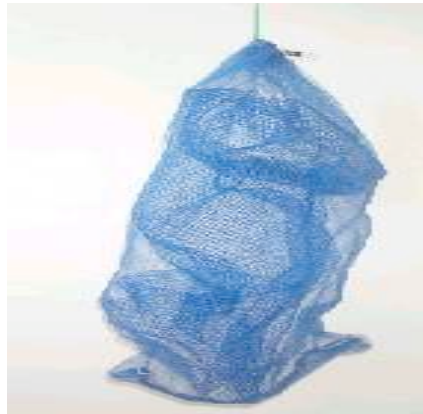
Figure 3 : Capteur composé d'un sac renfermant quatre bandes de « netron ».
